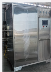
5 吨/天阳极氧化酸回收装置
