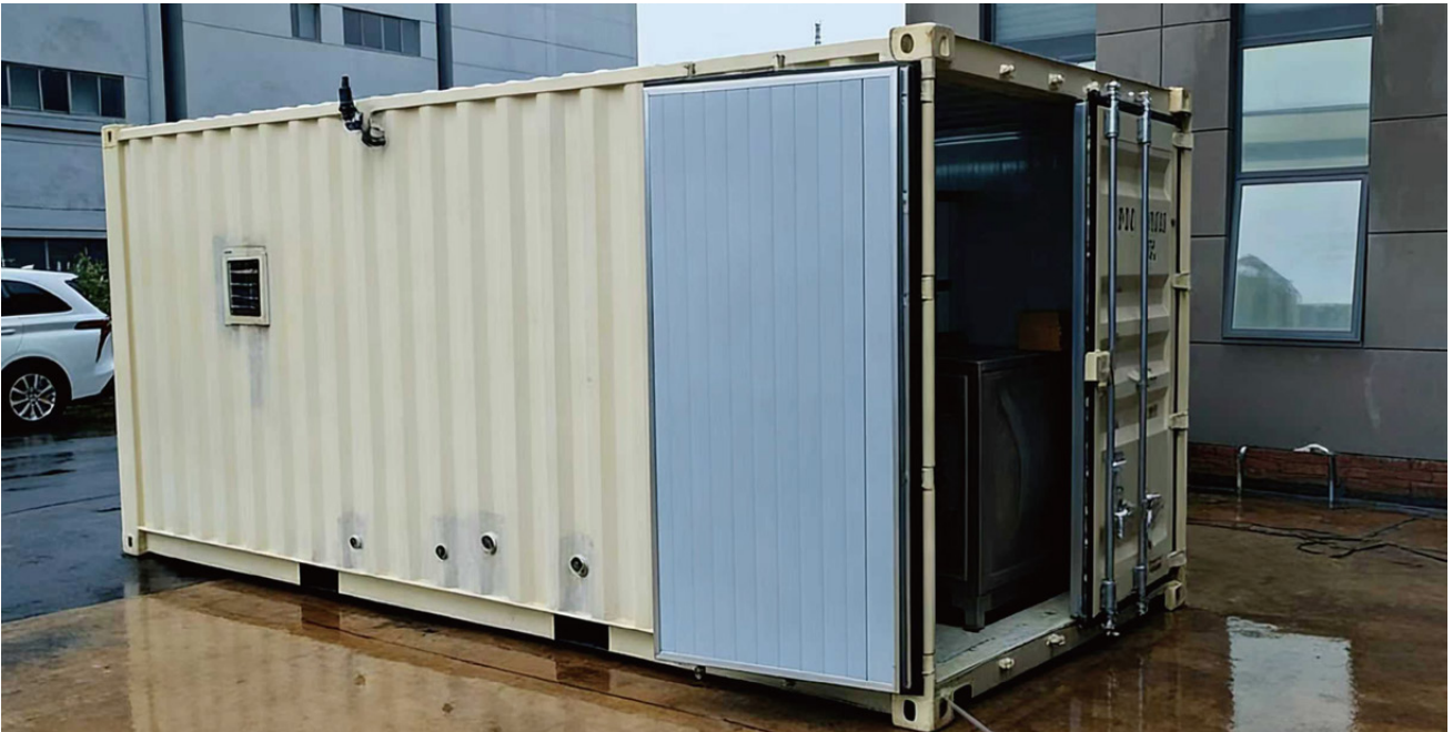
中空纤维纳滤膜中试运行装置
