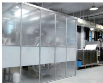
建成 1000 mm 幅宽纳滤膜规模化制备生产线，产能达 50 万平米 / 年
