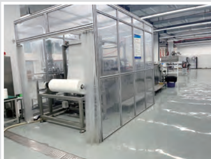
平板膜铸膜线
