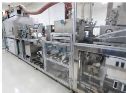
建成 300 mm 幅宽纳滤膜小试线
