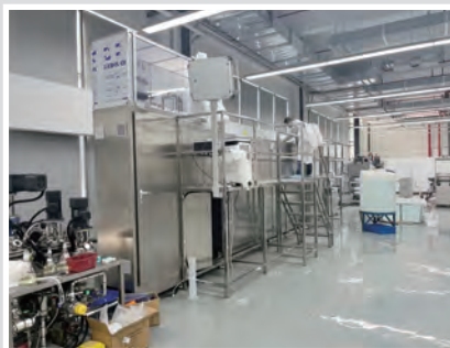
中空纤维膜生产线
