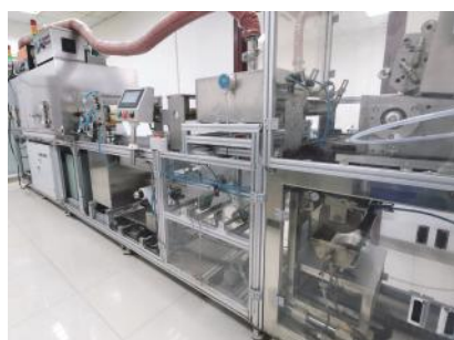
建成 300 mm 幅宽纳滤膜小试线
